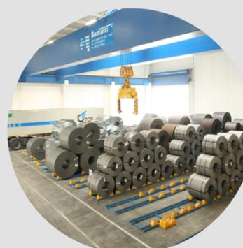
Due gru a ponte da 50 ton interne al deposito e una flotta di carrelli elevatori per coils
